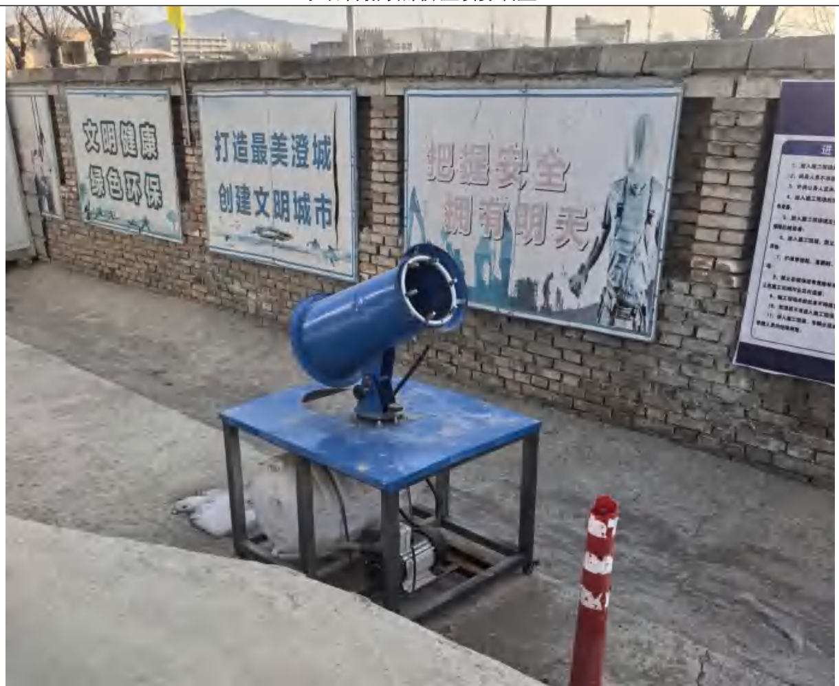
厂区雾炮设施
